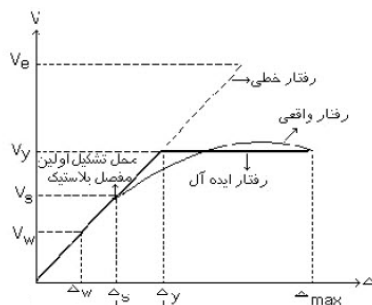
شکل ۱۰: منحنی‌های رفتار الاستیک و غیر الاستیک سازه‌ها
