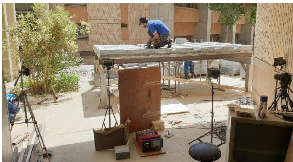
شکل ۶: نمای کلی آرایش دستگاه‌ها و تجهیزات آزمایش بارگذاری گسترده‌ی نمونه‌ی کامپوزیت
