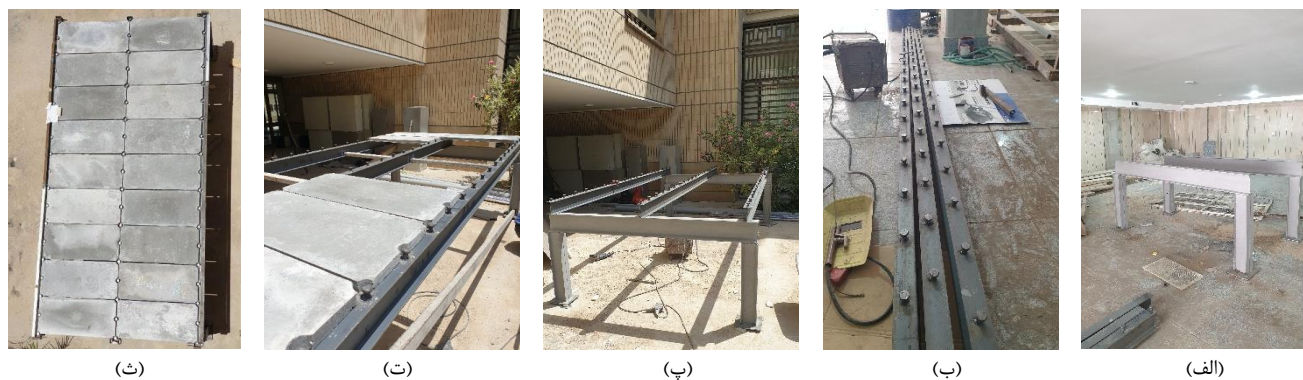
شکل ۴: مراحل ساخت نمونهی کامپوزیت. (الف) تیر و ستون سازهی نگهدارنده، (ب) جوش دادن گل‌میخ‌ها روی تیرهای IPE140، (پ) نصب سازهی نگهدارنده، (ت) جایگذاری دال‌های پیش ساخته روی تیرهای IPE140 و (ث) نمونهی کامپوزیت پس از جایگذاری دال‌های پیش ساخته.
