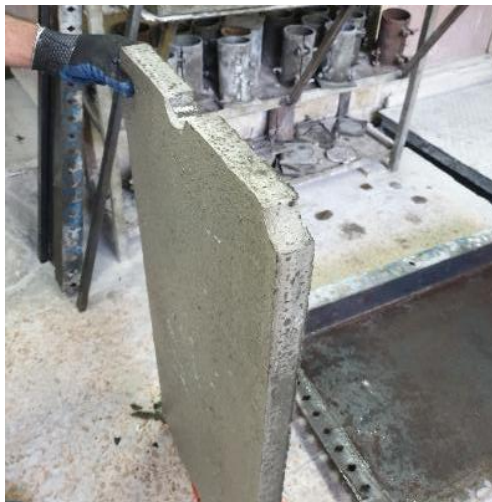
شکل ۳: دال پیش ساخته‌ی نمونه‌ی کامپوزیت.
