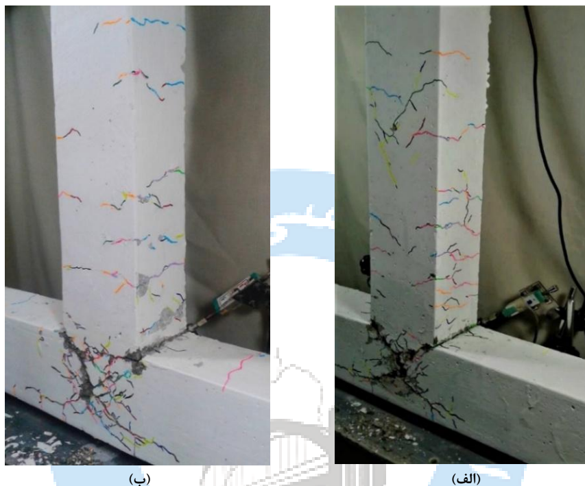
شکل ۷: مود شکست (در نسبت تغییر مکان جانبی ۷/۰٪) برای نمونه (الف) SPM400 (ب) نمونه SPM600
