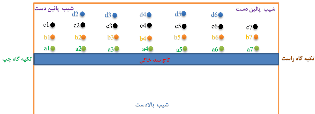
شکل ۲۵: پلان جانمایی نقاط میکروژئودزی در شیب پایین دست سد خاکی شیاده
