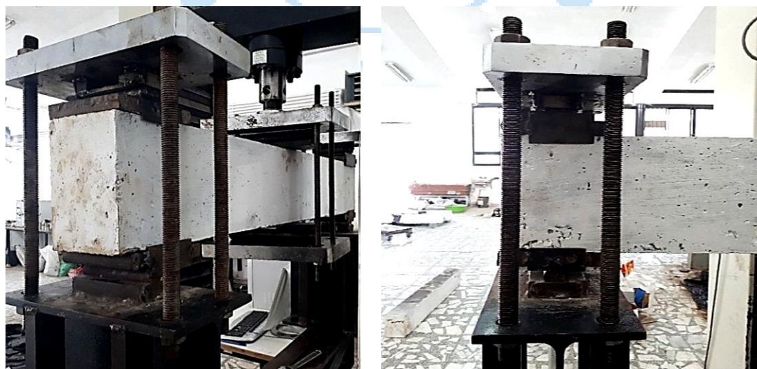
شکل ۵. دستگاه بارگذاری و اجرای تکیه گاه‌ها.
