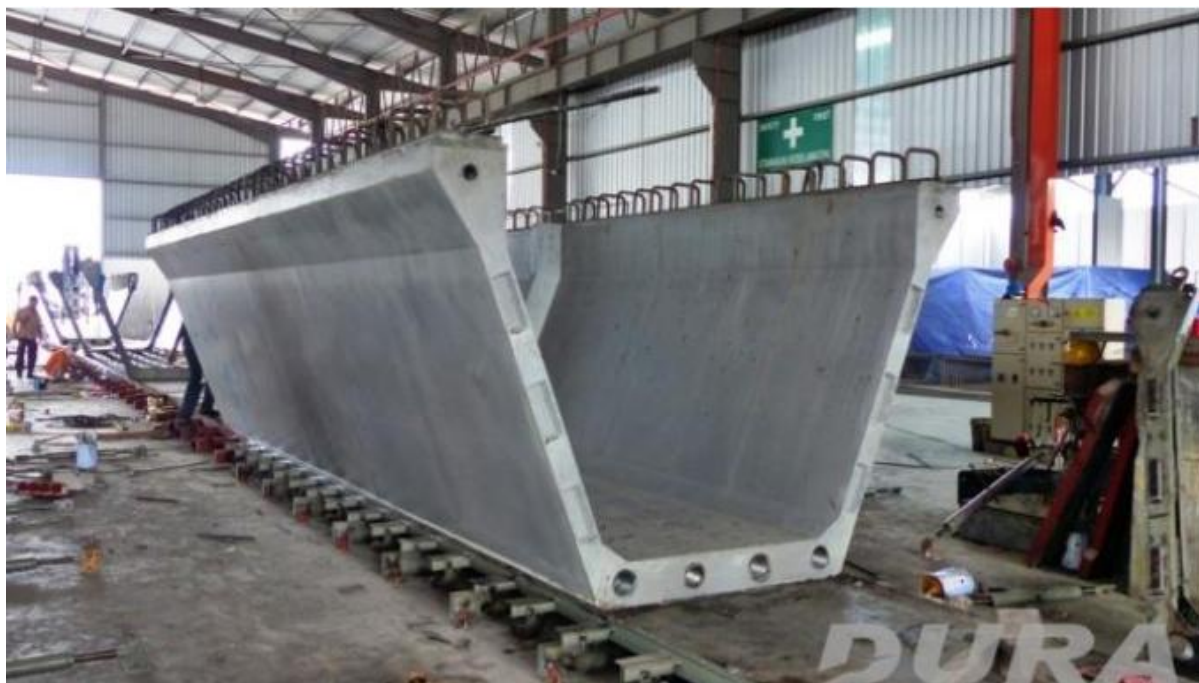
شکل ۱۰- ساخت قطعات II شکل در کارخانه [۳۲].
