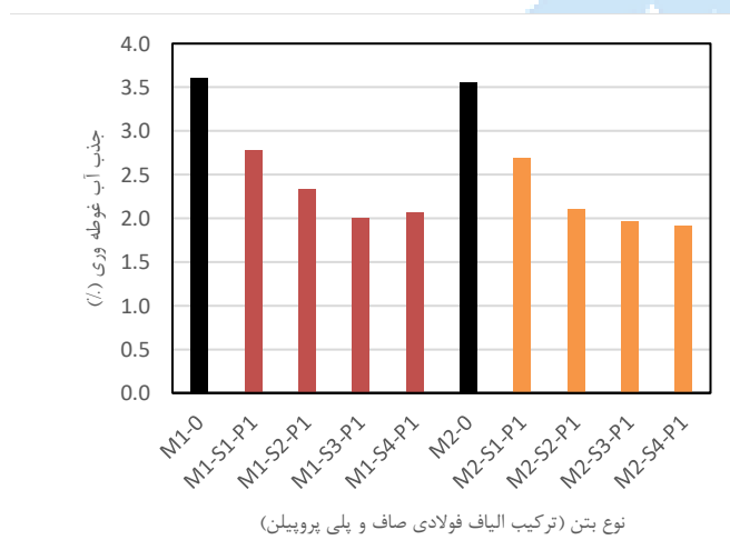
شکل ۱۴ - جذب آب غوطه‌وری ۱۸۰ روزه مخلوط‌های ۱ و ۲ با ترکیب الیاف فولادی صاف و پلی پروپیلن
