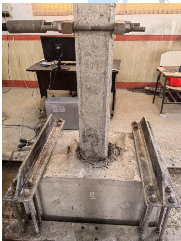
شکل ۱۹: گسیختگی نمونه‌ی ۶ با درصد میلگرد ۴٪ و جهت خم میلگرد به سمت خارج هسته‌ی ستون
