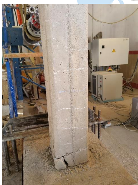
شکل ۱۵: گسیختگی نمونه‌ی ۲ با درصد میلگرد ۰.۱٪ و جهت خم میلگرد به سمت خارج هسته‌ی ستون
