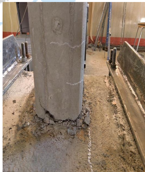
شکل ۱۴: گسیختگی نمونه‌ی ۱ با درصد میلگرد ۰.۱٪ و جهت خم میلگرد به سمت داخل
