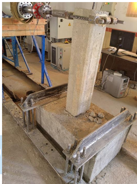
شکل ۱۶: گسیختگی نمونه‌ی ۳ با درصد میلگرد ۲٪ و جهت خم میلگرد به سمت داخل هسته‌ی ستون
