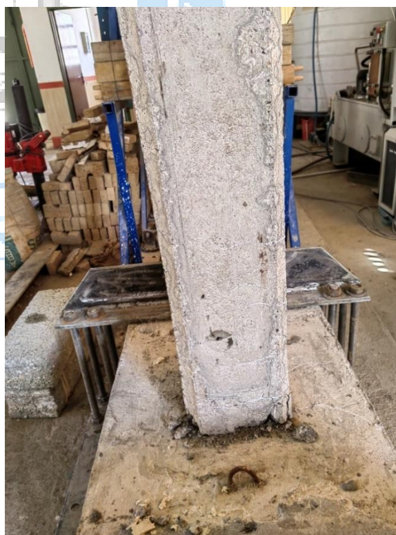
شکل ۱۸: گسیختگی نمونه‌ی ۵ با درصد میلگرد ۴٪ و جهت خم میلگرد به سمت داخل هسته‌ی ستون
