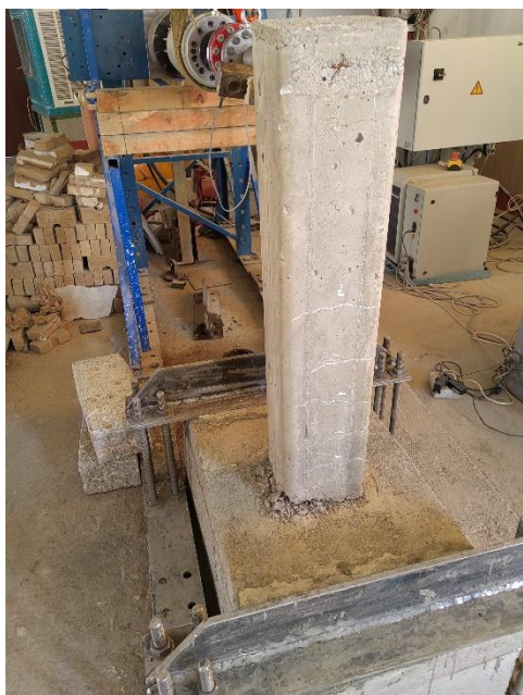
شکل ۱۷: گسیختگی نمونه‌ی ۴ با درصد میلگرد ۲٪ و جهت خم میلگرد به سمت خارج هسته‌ی ستون
