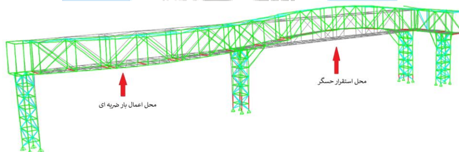
شکل ۱۳: مدل اجزاء محدود پل فلزی سوم و محل‌های اعمال بار ضربه‌ای و ثبت پاسخ ارتعاشی سازه
