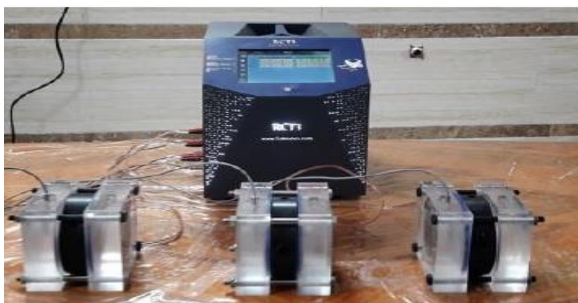
شکل ۹: نحوه انجام آزمایش RCPT
