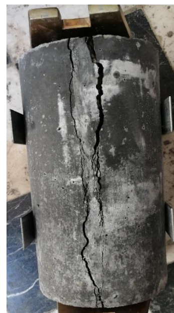
شکل ۱۲: گسیختگی نمونه بتن حاوی ۱/۷۵٪ الیاف بازالت بعد از اعمال بار
