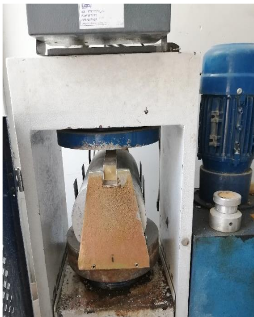
شکل ۷: نمونه استوانه ای تحت آزمایش مقاومت کششی بروش دو نیم شدن
