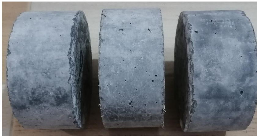
شکل ۸: نمونه استوانه ای برش خورده شده برای قرار گیری در سلول آزمایش RCPT
