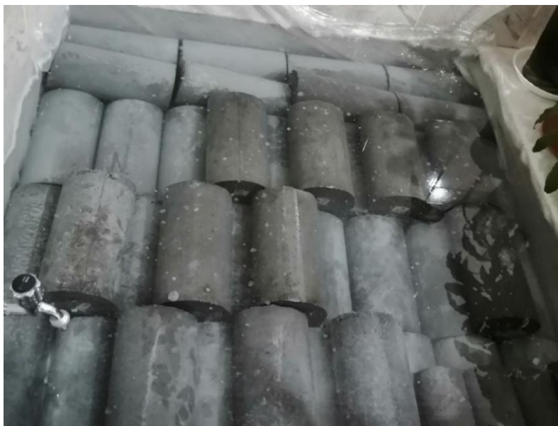
شکل ۵: حوضچه عمل آوری نمونه های بتن سبک
