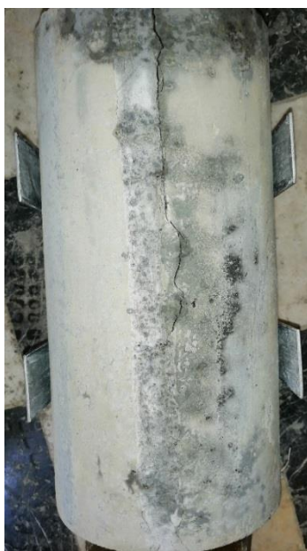
شکل ۱۳: گسیختگی نمونه سبک حاوی ۱/۷۵٪ الیاف ترکیبی بعد از اعمال بار
