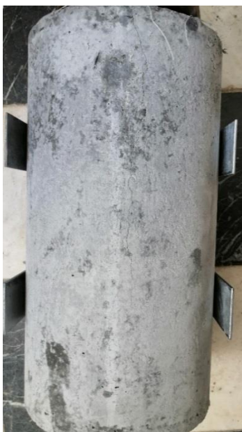
شکل ۱۱: گسیختگی نمونه سبک حاوی ۱٪ الیاف پلیمری بعد از اعمال بار
