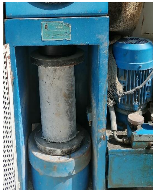
شکل ۶: نمونه استوانه ای تحت آزمایش مقاومت فشاری
