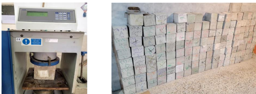
شکل ۱۹: نمونه‌های بتن خودتراکم ساخته شده و شکست نمونه بتن مکعبی با دستگاه مقاومت فشاری تک محوره
