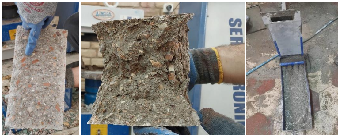
شکل ۵ برخی از آزمایش‌ها صورت گرفته بر روی نمونه‌ی دارای خرده سرامیک ضایعاتی جایگزین درشت‌دانه
