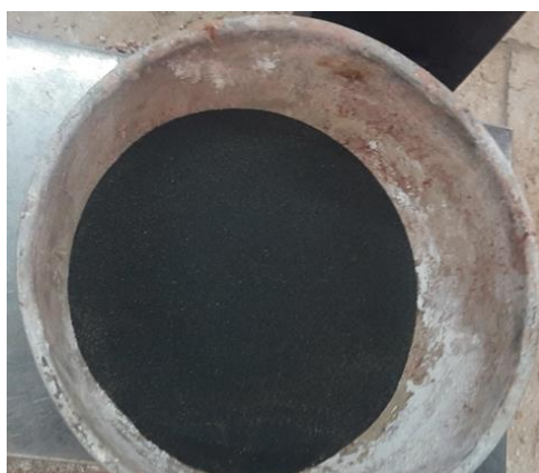
شکل ۴ پودر ایلمنیت مصرفی جهت ساخت بتن سنگین
