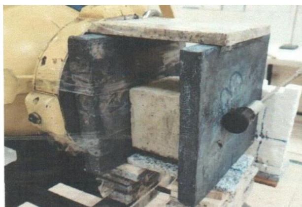
شکل ۶ اندازه گیری بوسیله آشکارساز گازی تلکتور (دزیمتر)
