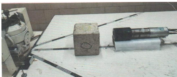
شکل ۷ اندازه‌گیری بوسیله آشکارساز یدور سدیم NaI و شمارشگر MC
