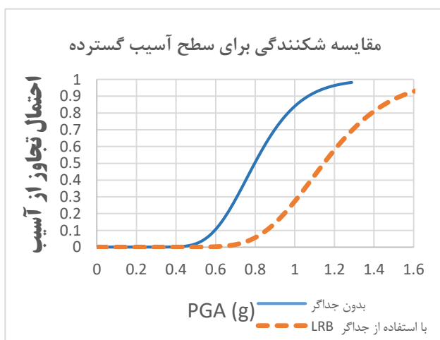
شکل ۲۰: مقایسه اثر استفاده از جداگر لرزه‌ای LRB بر روی منحنی‌های شکنندگی نمونه پل مورد مطالعه در حالت آسیب گسترده (DC3)
