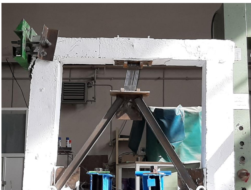
شکل ۱۸: قاب بتنی با میراگر تسلیمی ADAS نمونه F-3-ADAS
