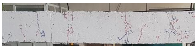
شکل ۱۲: نحوه ترک خوردگی نمونه Conc-F-3 بعد از آزمایش.
