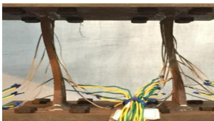
شکل ۱۱-هندسه تغییر شکل یافته در نمونه عددی و مدل صحت سنجی [16]
