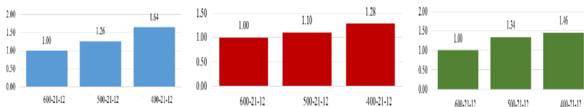
شکل ۱۶: مقایسه قاب با میراگر به ضخامت ۲۱ میلی‌متر از لحاظ سختی، مقاومت و جذب انرژی
