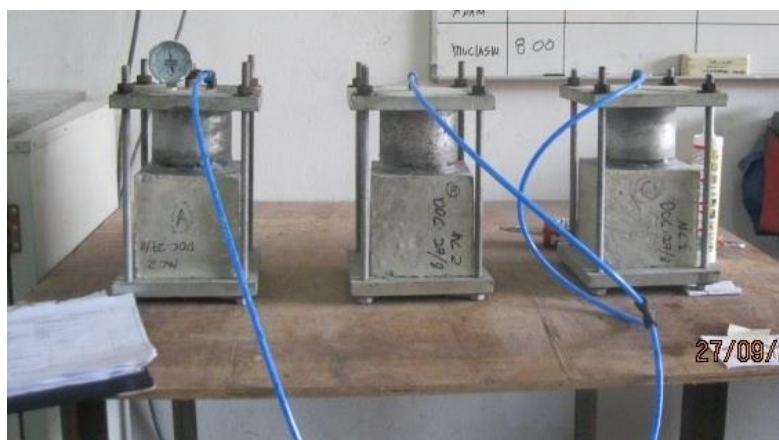
شکل ۷: آزمایش نفوذپذیری آب در بتن.
