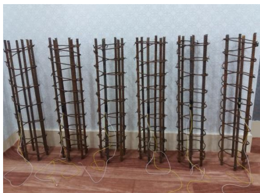
شکل ۲- نحوه نصب کرنش‌سنج‌ها روی میلگردها
