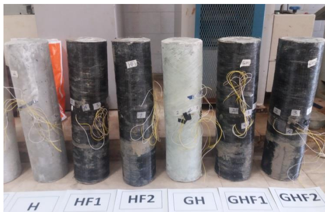
شکل ۵- ستون‌های تحقیق بعد از اعمال دورپیچ CFRP
