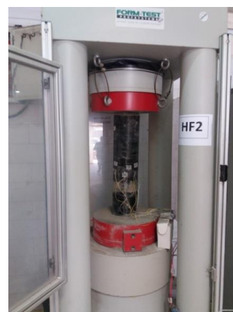
شکل ۷- نحوه انجام آزمایش و قرارگیری ستون‌ها در جک
