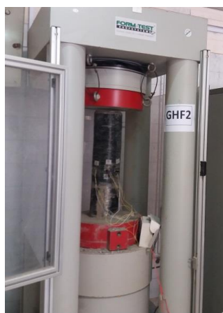
شکل ۷- نحوه انجام آزمایش و قرارگیری ستون‌ها در جک
