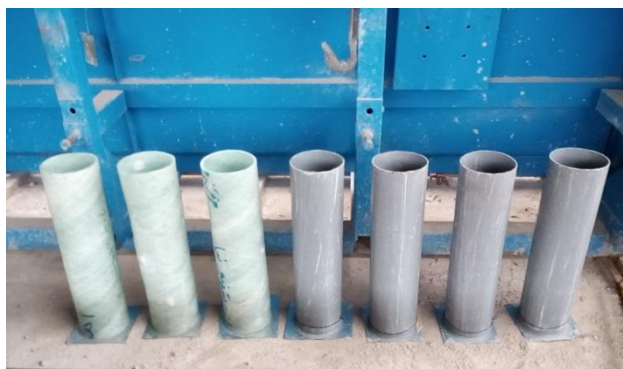
شکل ۳- لوله‌های GRP و قالب‌های PVC
