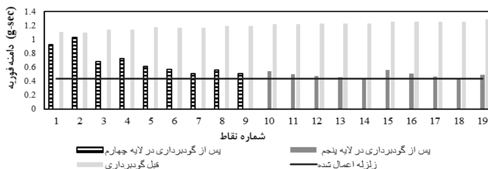
شکل ۱۸: بیشینه دامنۀ فوریه نقاط واقع در ناحیه روانگرا شده و زلزله اعمالی (مدل اول).
