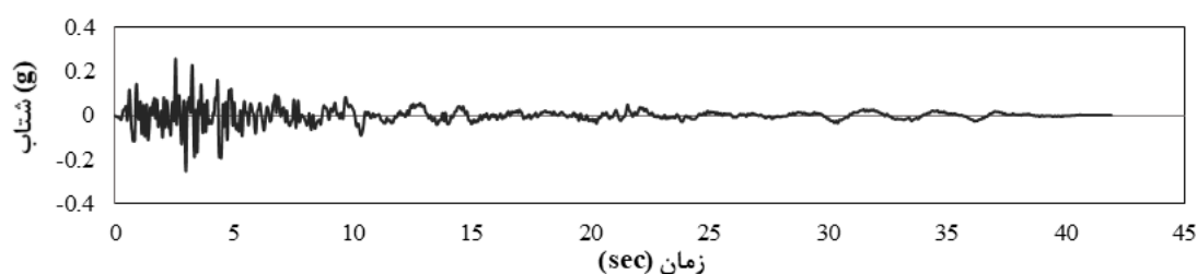
شکل ۲: نمودار شتاب-زمان ثبت شده زمین لرزه پارکفیلد توسط نرم افزار Seismosignal.
