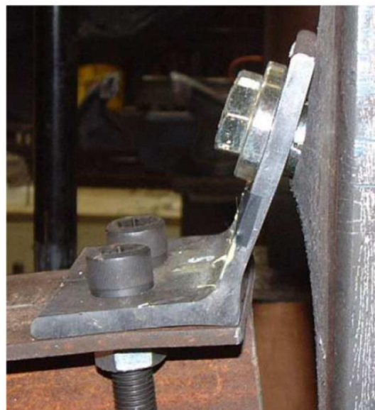
شکل ۱۱: مقایسه خرابی اتصال تحلیل پژوهش با نمونه واقعی (تجربی) [7] بر اساس معیار توزیع تنش فون میز بر حسب N/mm^2
