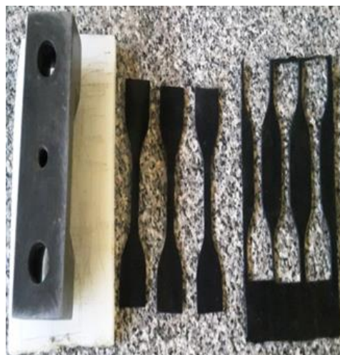
شکل ۳ نمونه‌های آماده شده جهت تست کشش.
