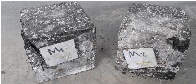
شکل ۱۲: چگونگی شکست نمونه‌های مکعبی حاوی خاکستر کاج.
