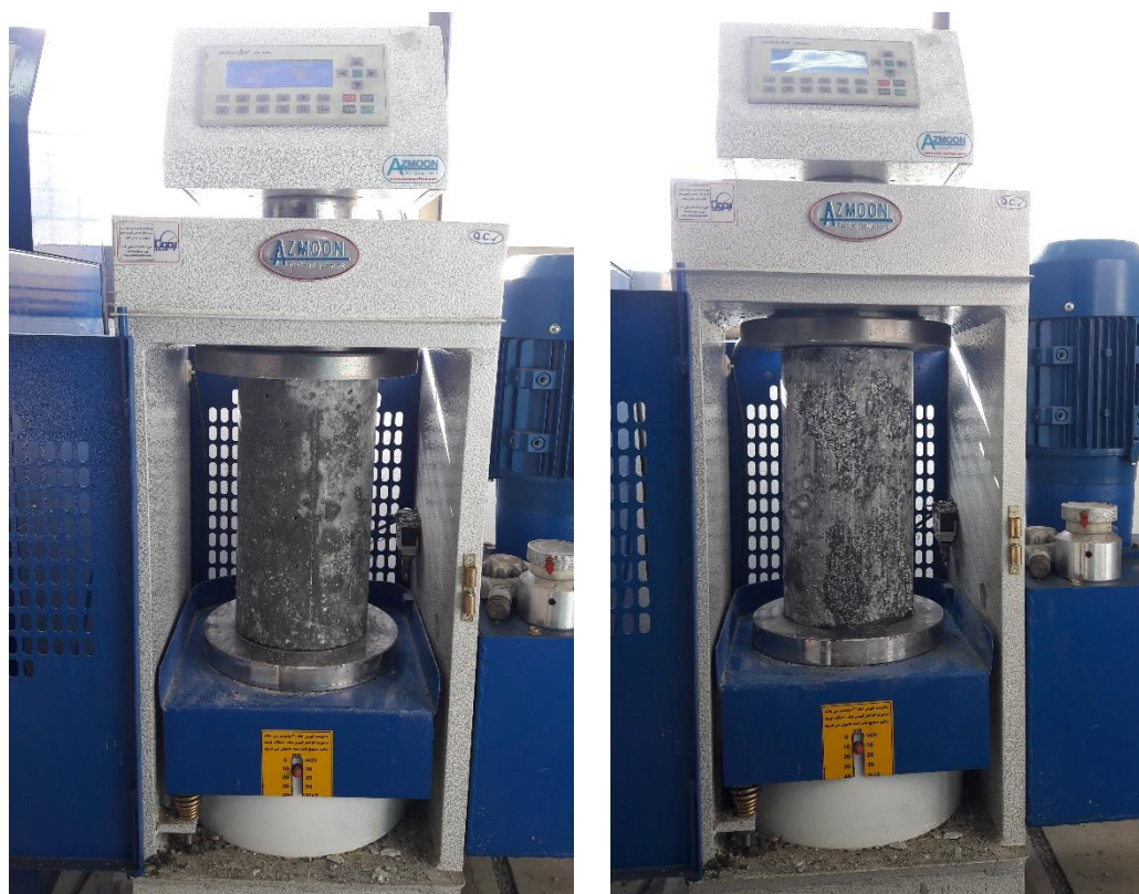
شکل ۷: قرارگیری نمونه‌های استوانه‌ای دارای خاکستر کاج در زیر جک.
