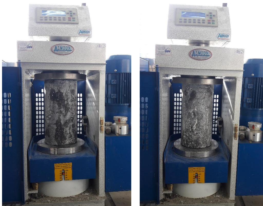
شکل ۶: قرارگیری نمونه‌های استوانه‌ای شاهد در زیر جک.
