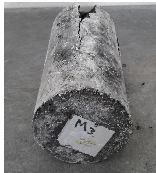
شکل ۱۴: چگونگی شکست نمونه‌های استوانه‌ای حاوی خاکستر کاج
