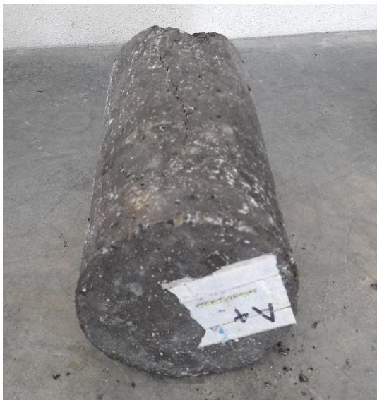
شکل ۱۳: چگونگی شکست نمونه‌های استوانه‌ای شاهد
