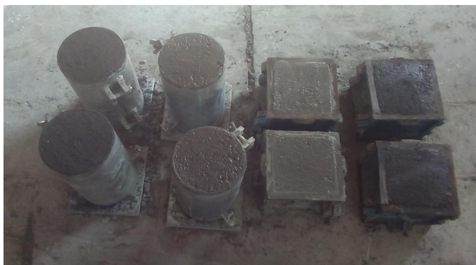
شکل ۲: نمونه‌ها پس از بتن‌ریزی.
