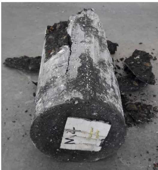
شکل ۱۴: چگونگی شکست نمونه‌های استوانه‌ای حاوی خاکستر کاج
