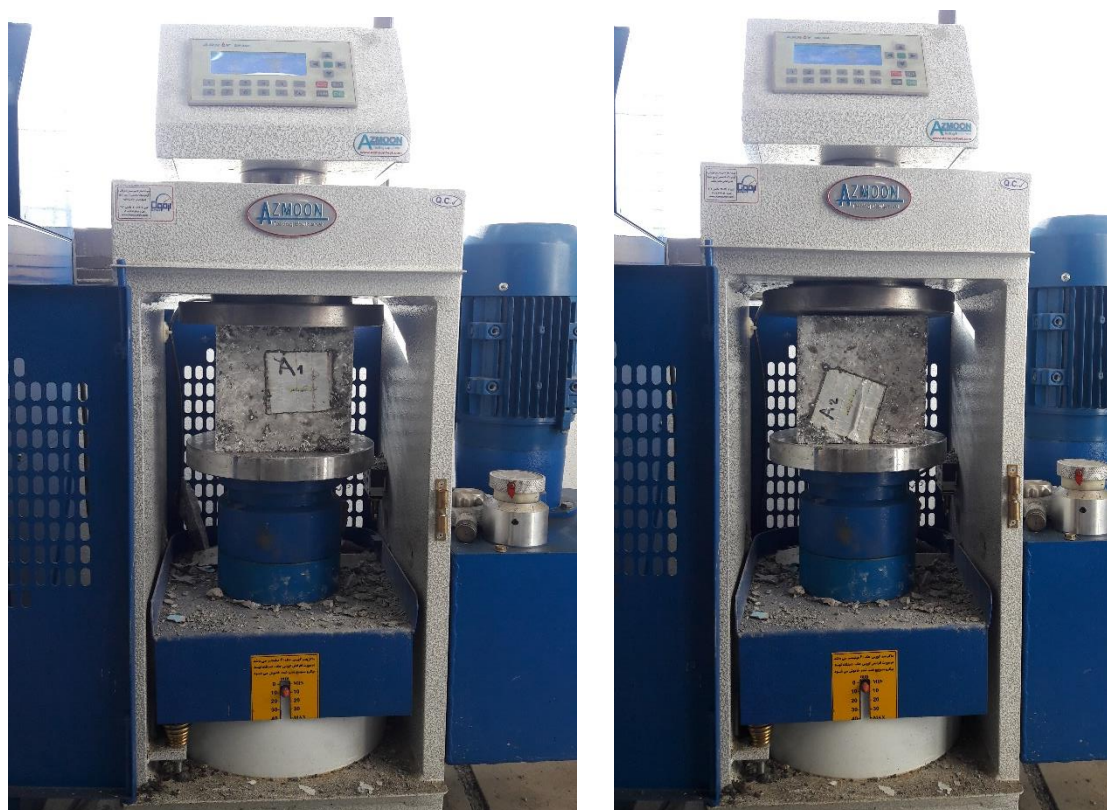
شکل ۴: قرارگیری نمونه‌های مکعبی شاهد در زیر جک.
