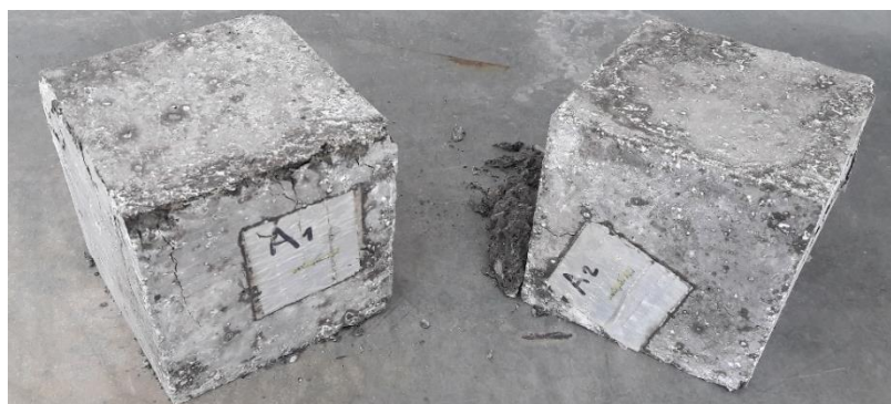
شکل ۱۱: چگونگی شکست نمونه‌های مکعبی شاهد
