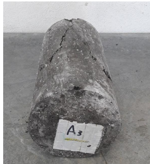
شکل ۱۳: چگونگی شکست نمونه‌های استوانه‌ای شاهد
