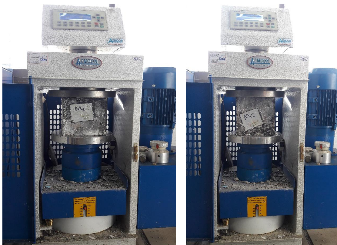
شکل ۵: قرارگیری نمونه‌های مکعبی دارای خاکستر کاج در زیر جک.
