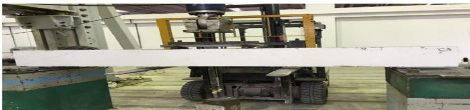
شکل ۳: نحوه‌ی بارگذاری خمش چهار نقطه‌ای تیرهای تهیه شده توسط شاترات و همکارانش [۹]
