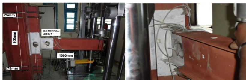
شکل ۵: تصاویری از بیکربندی مدل آزمایشگاهی اتصال تیر با سطح مقطع کاهش یافته و مدلسازی نرم افزاری آن [۳۰]
