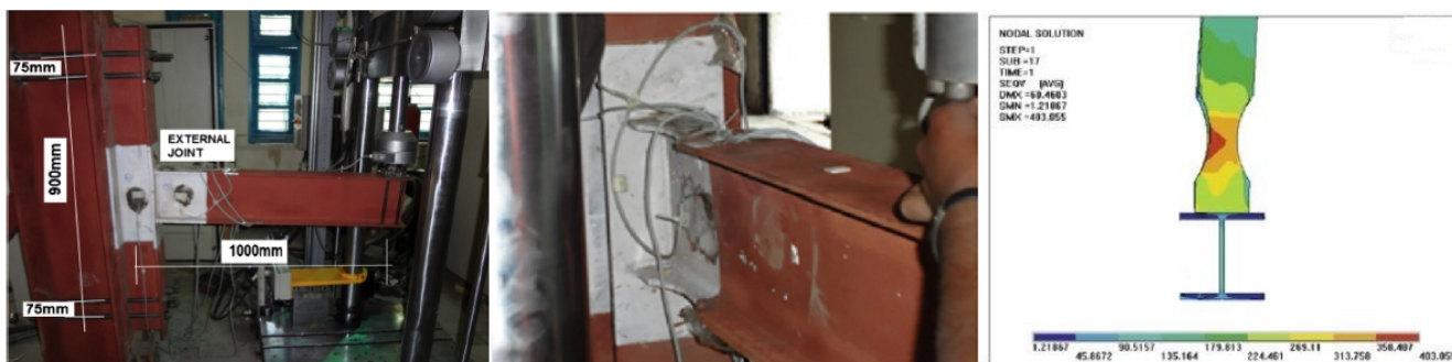
شکل ۳: تصاویری از پیکربندی مدل آزمایشگاهی اتصال تیر با سطح مقطع کاهش یافته و مدل سازی نرم افزاری آن [۲۰]
