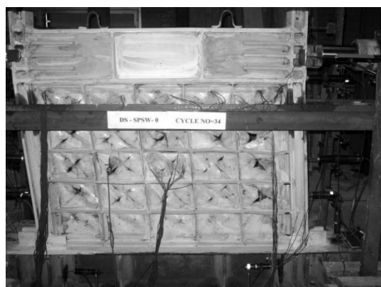
شکل ۵: مدل آزمایشگاهی دیوار برشی فولادی با سخت‌کننده (صبوری و اسعد سجادی) [۱۵]
