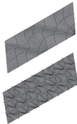
شکل ۳: مودهای مختلف کمانش ورق: کمانش کلی (بالا)، کمانش موضعی در زیر صفحات (پایین) [۶]
