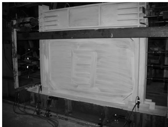
شکل ۴: مدل آزمایشگاهی دیوار برشی فولادی بدون سخت‌کننده (صبوری و اسعد سجادی) [۱۸]
