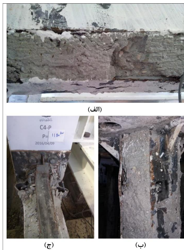
شکل ۴: مود تسلیم و کمانش بال، خردشدگی بتن و پاره شدن جوش لینک‌ها: الف) PEC-C، ب) PEC-CL و ج) PEC-CLS
