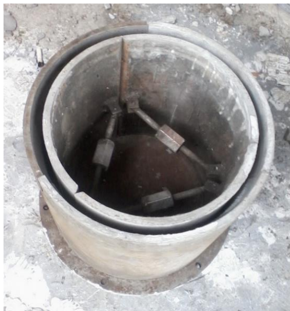
شکل ۲: قالب استفاده شده برای ساخت پوسته استوانه ای
