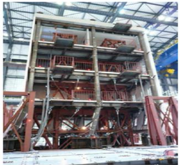
شکل ۵: مدل آزمایشگاهی با مقیاس واقعی در میز لرزه ای مرکز دفاعی ژاپن [۳۳] و قاب دو دهانه ی مدل سازی شده جهت صحت سنجی.
