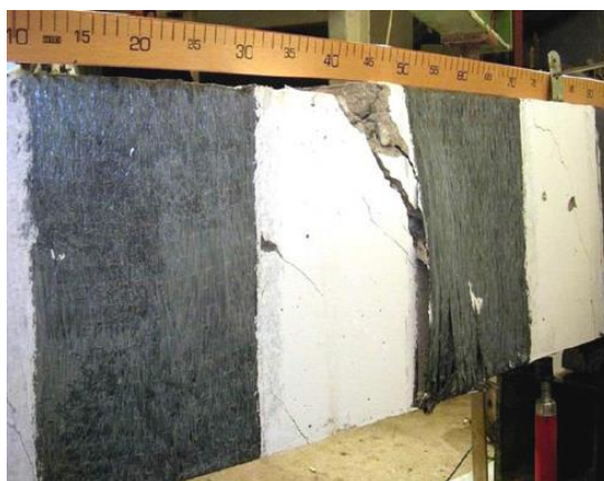
شکل ۳: ورق FRP به صورت دورپیچ گسسته دور تیر [۲۵].
