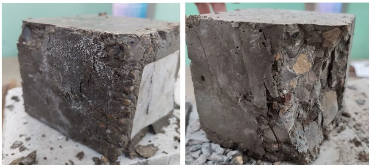
شکل ۹: الگوی شکست فشاری نمونه شاهد.
