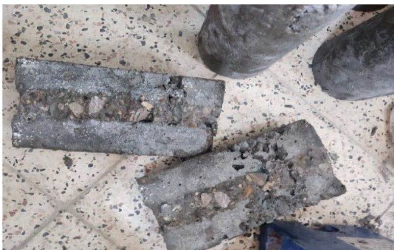
شکل ۱۳: الگوی شکست نمونه دارای کلیدبرشی.
