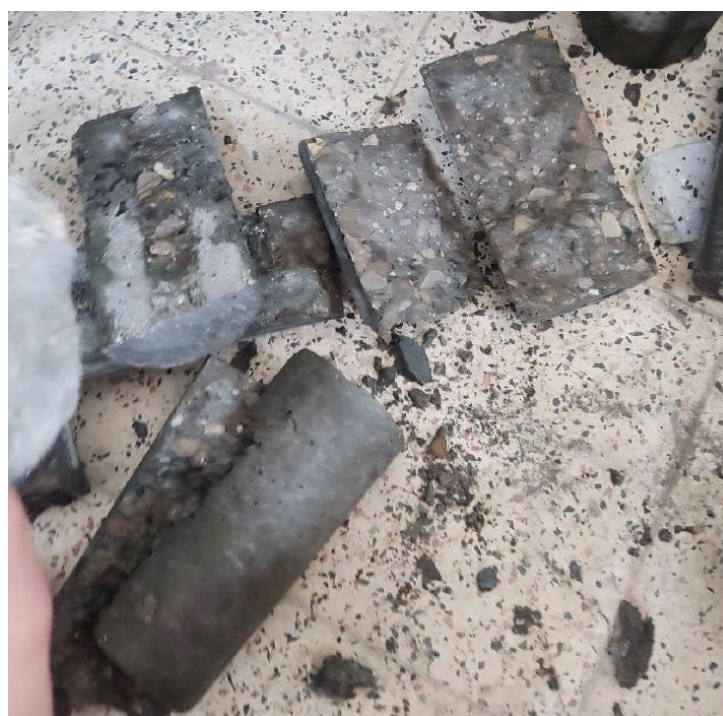
شکل ۱۴: الگوی شکست نمونه دارای درز سرد.
