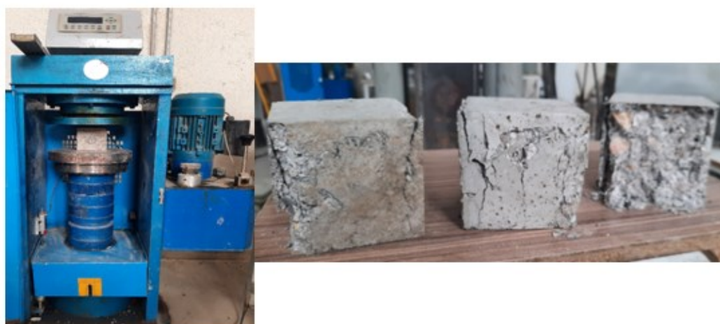
شکل ۲: آزمایش مقاومت فشاری نمونه ها.
