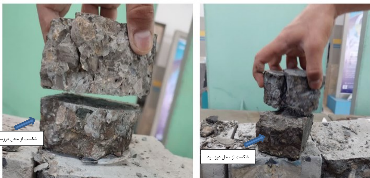
شکل ۱۰: الگوی شکست فشاری نمونه دارای درز سرد.
