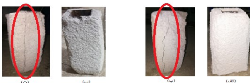
شکل ۶: الف) نمونه با پوشش ضد حریق گچی قبل از حرارت ۱۰۰۰ درجه سانتی گراد، ب) نمونه با پوشش ضد حریق گچی بعد از حرارت ۱۰۰۰ درجه سانتی گراد، پ) نمونه با پوشش سیمانی قبل از حرارت ۱۰۰۰ درجه سانتی گراد، ت) نمونه با پوشش سیمانی بعد از دمای ۱۰۰۰ درجه سانتی گراد.
