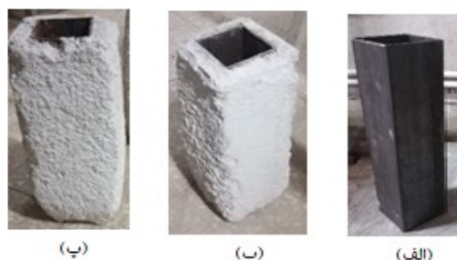
شکل ۲: (الف) نمونه بدون پوشش ضد حریق، (ب) نمونه با پوشش ضد حریق گچی و (ج) نمونه با پوشش ضد حریق سیمانی.
