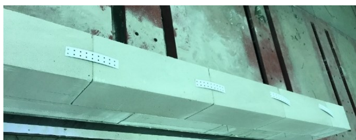
شکل ۴: تسمه های فولادی نصب شده بین بلوک های AAC در رجهای افقی دیوار.
