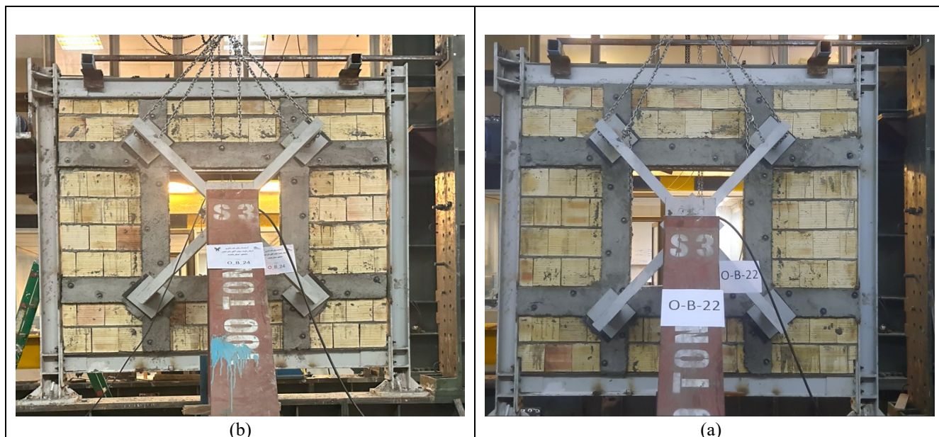
شکل ۱: (a) نمونه‌ی D2 میان قاب تقویت شده متکی به قاب. (b) نمونه‌ی D3 میان قاب تقویت شده جدا از قاب.
