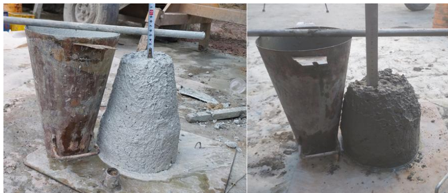
شکل ۱۰ مقایسه اسلامپ بتن معمولی با بتن خود تمیز شونده
