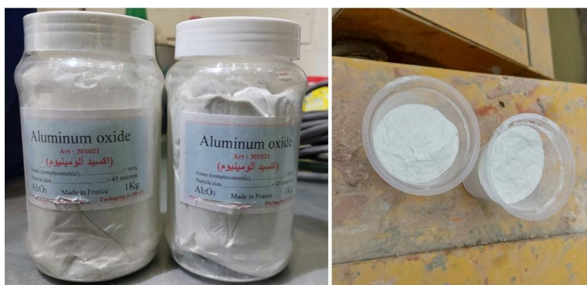
شکل ۷ دی اکسید آلومین مصرفی جهت تقویت مقاومت سایشی بتن خودتمیزشونده
