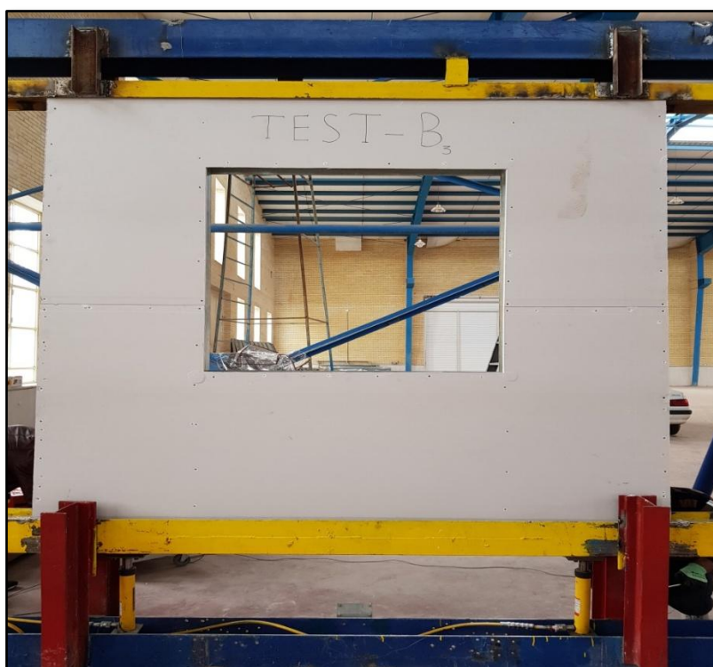
شکل ۳: نمای کلی از دیوار مورد آزمایش و جک هیدرولیکی آزمایشگاه
