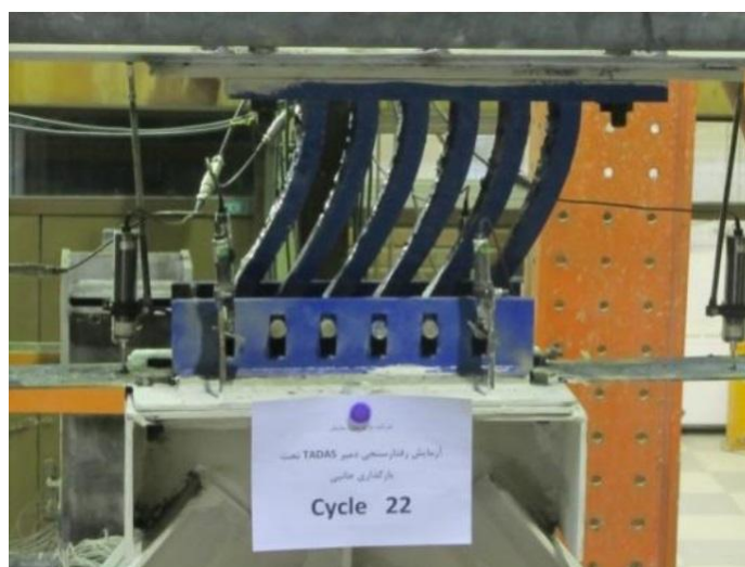
شکل ۷: تغییر شکل ایجاد شده در میراگر تاداس حین انجام آزمایش [۲۰].
