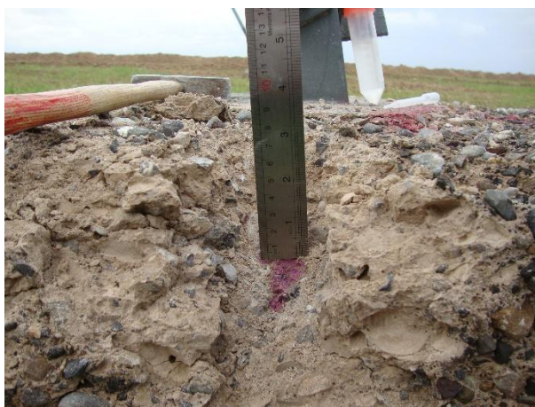
شکل (۴): فرآیند آزمون تعیین عمق کربناته شدن بتن.
