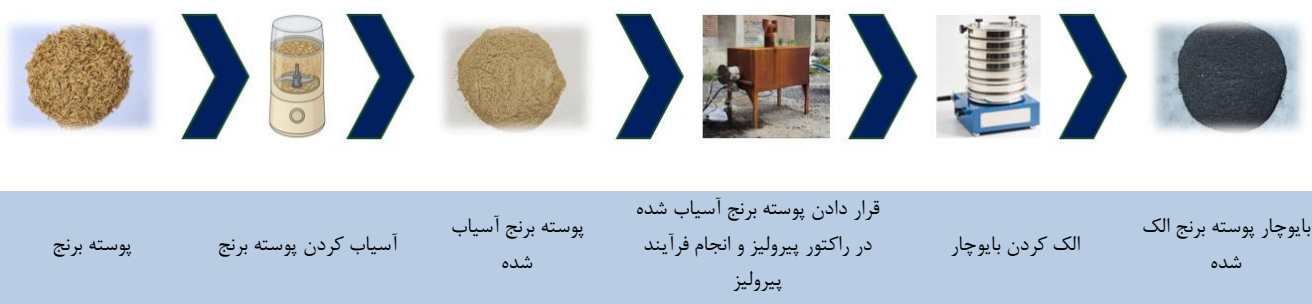
شکل ۳: فرآیند تولید بایوچار از پوسته برنج
