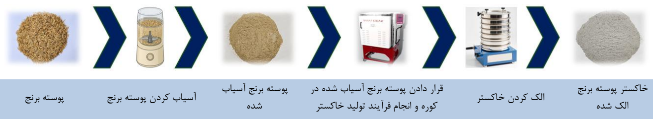
شکل ۴: فرآیند تولید خاکستر از پوسته برنج
