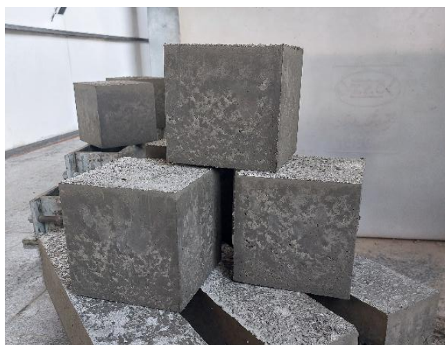
شکل ۵: نمونه‌های عمل‌آوری شده با ماده عمل‌آورنده
