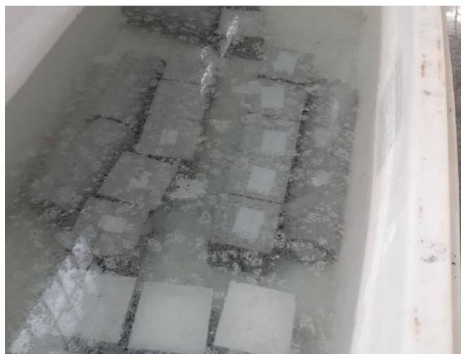
شکل ۲: نمونه‌های عمل آوری شده در حوضچه آب
