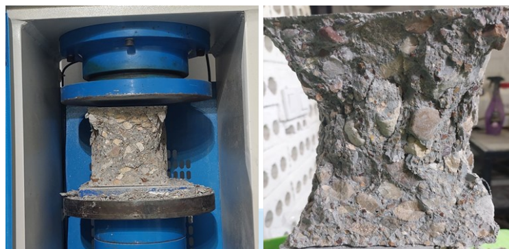
شکل ۸ تصاویری مربوط به آزمایش مقاومت فشاری بتن
