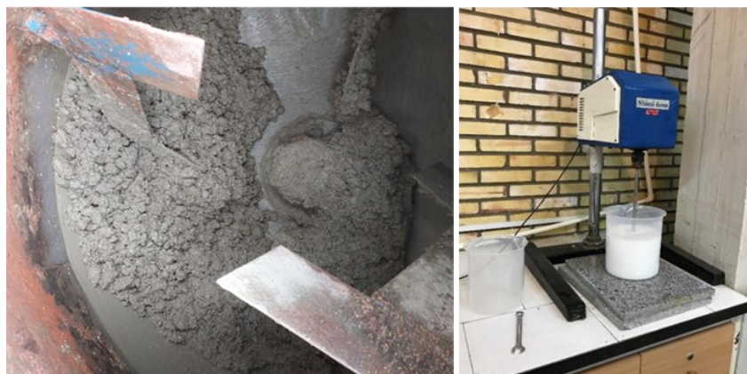
شکل ۵ تصاویری از مخلوط بتن به همراه محلول نانو دی اکسید آنتیموان به همراه ابر روان کننده
