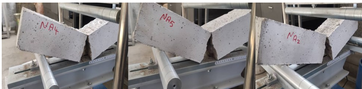
شکل ۱۲ تصاویری مربوط به آزمایش مقاومت خمشی بتن
