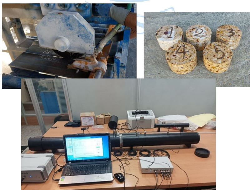
شکل ۱۴ برشکاری، آماده‌سازی و آزمایش افت انتقال صوت با لوله امپدانس
