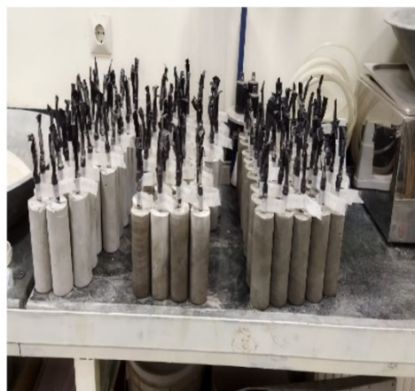
شکل ۴: آماده سازی آزمونه های حاوی آرماتور جهت آزمایش نیم پیل
