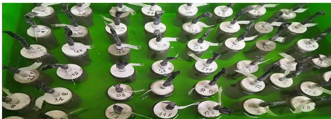
شکل ۵: قراردادن نمونه‌های آزمایش نیم‌پیل در محلول ۱۰ درصد NaCl
