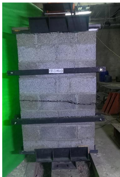
شکل ۱۵: تصاویر گسیختگی در نمونه‌های تسلیح میان‌رجی
