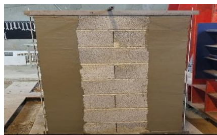
شکل ۷: توالی مراحل اجرای مش قائم روی دیوار بنایی
