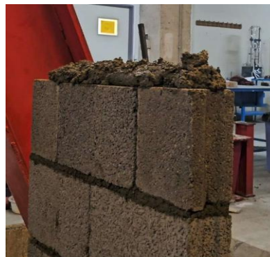
شکل ۵: بلوک چینی نمونه های قائم
