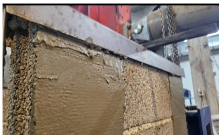
شکل ۷: توالی مراحل اجرای مش قائم روی دیوار بنایی
