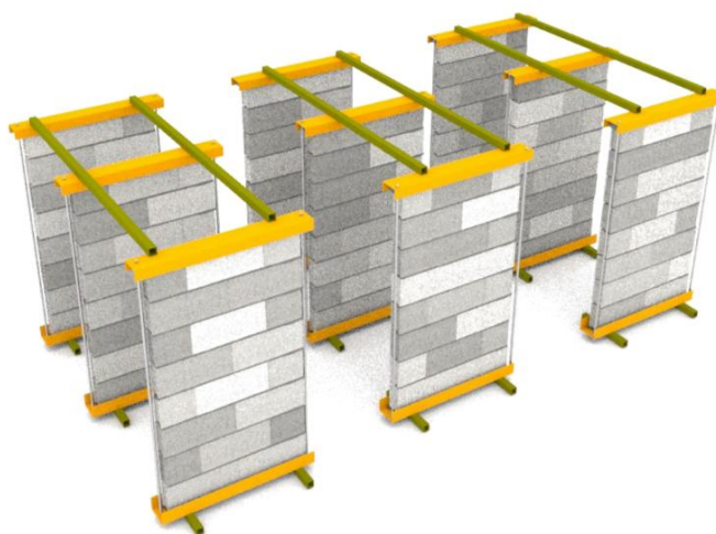
شکل ۸: نحوه کلاف کردن نمونه‌ها در محیط نگهداری آزمایشگاه
