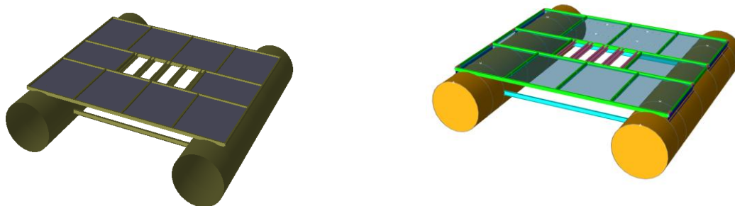
شکل ۲: سازه شناور مدل‌سازی عددی شده (الف) در نرم افزار SACS و (ب) در نرم افزار سسم
