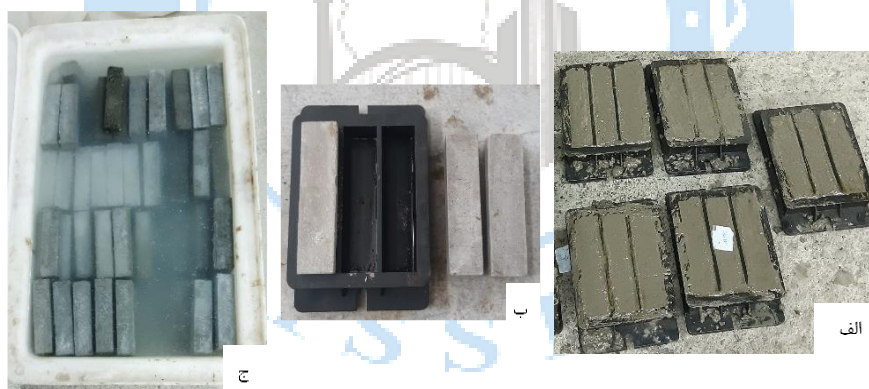
شکل ۴: روند ساخت تا آزمایش، (الف) ملات ریخته شده درون قالب، (ب) نمونه‌های خارج شده از قالب، (ج) فرآوری نمونه‌ها داخل مخزن آب
