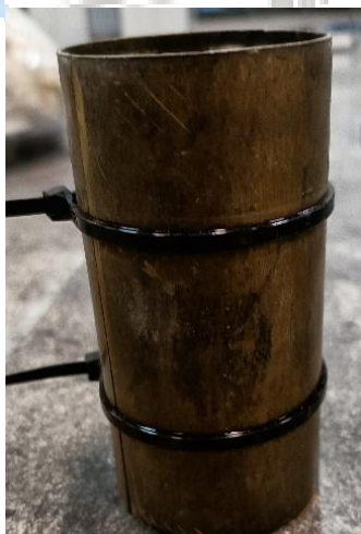
شکل ۵: قالب‌های ساخت نمونه‌های بهسازی
