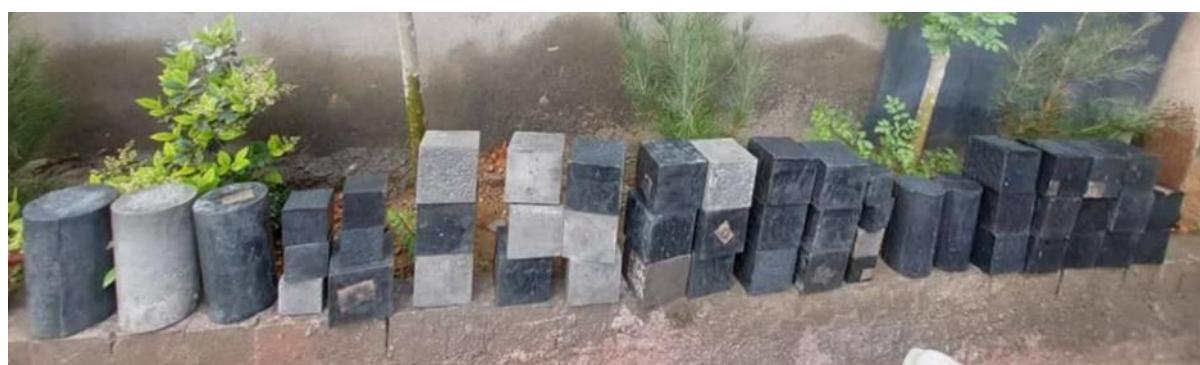
شکل ۵ برخی از نمونه‌های ساخته شده قبل از عمل آوری در حوضچه آب
