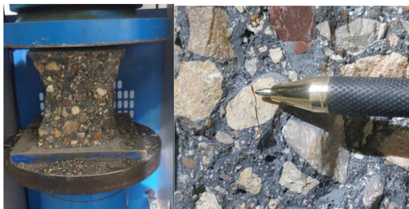
شکل ۱۲ شکست نمونه بتنی تحت آزمایش مقاوم فشاری و نمایش درشت دانه (شن که در اثر فشار شکسته شده)
