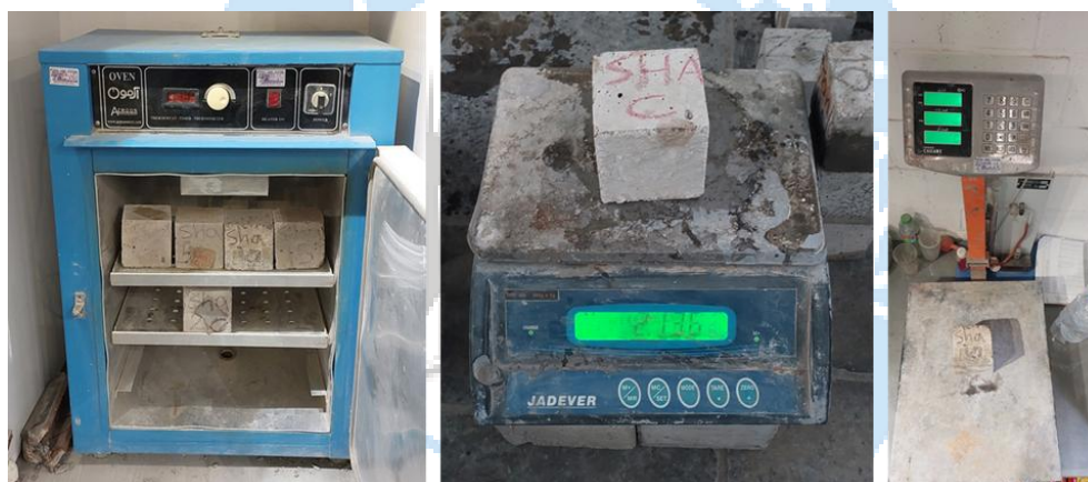
شکل ۱۵ آزمایش جذب آب در بتن سخت شده
