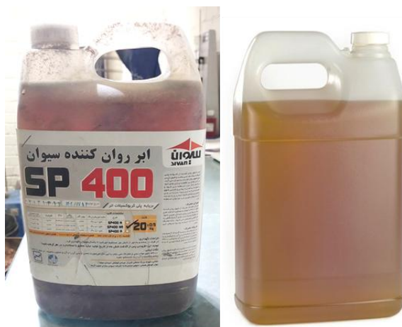
شکل ۴ ابر روان کننده مصرفی بر پایه پلی کربوکسیلات و خواص ضد قارچ و ضد کپک
