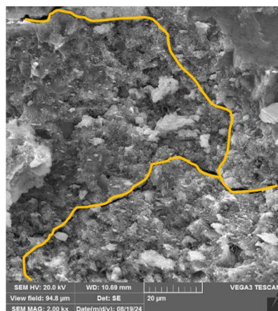
شکل ۲۲ نمایش ترک ایجاد شده در اثر ضعف ناشی از افزودن پسماند قهوه و زوال خمیره سیمان
