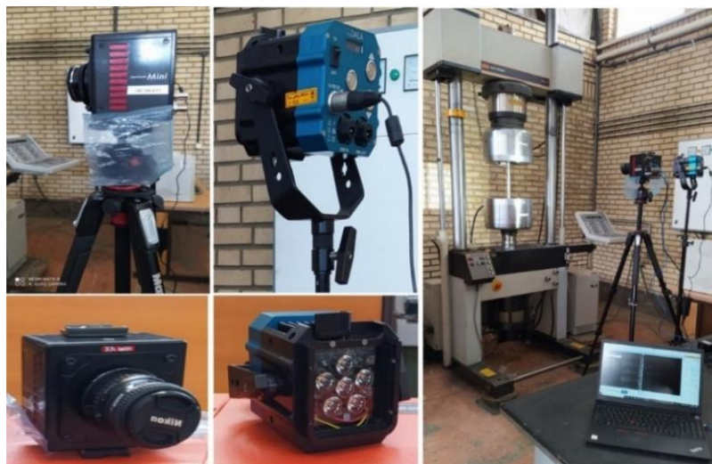
شکل ۵: تجهیزات مربوط به تصویربرداری دیجیتال (DIC) شامل دوربین، نورافن، لپ تاپ و دستگاه کشش اینسترون
