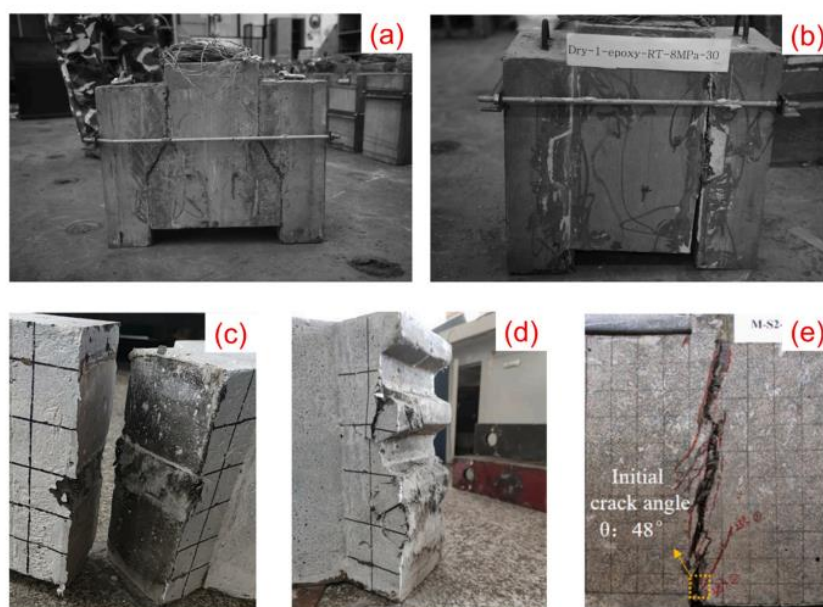
شکل ۶- حالت‌های شکست انواع مختلف مفاصل: (a) مفصل مرطوب [۴۷]، (b) مفصل اپوکسی [۴۷]، (c) مفصل اپوکسی [۶۷]، (d) مفصل خشک [۶۷]، و (e) رابط یکپارچه [61]
